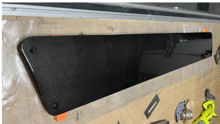
Dérive en carbone moulé noyau en mousse époxy. (Même dérive que le PaperJet).
